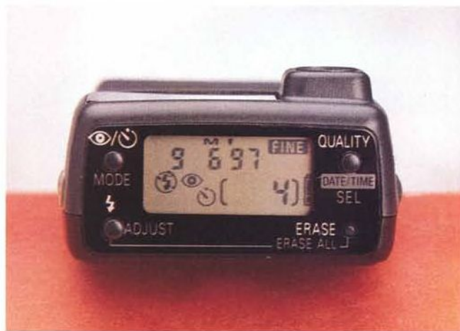
La "sezione fotocamera" della COOLPIX 100 è di dimensioni veramente ridotte. Incorpora un flash elettronico e un display LCD per regolare le varie funzioni.
